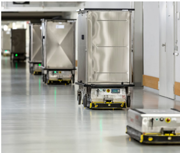
Das fahrerlose Transportsystem greift auf Funktechnologien zurück (rechts). Links: Die selbstfahrenden Container im Einsatz.
